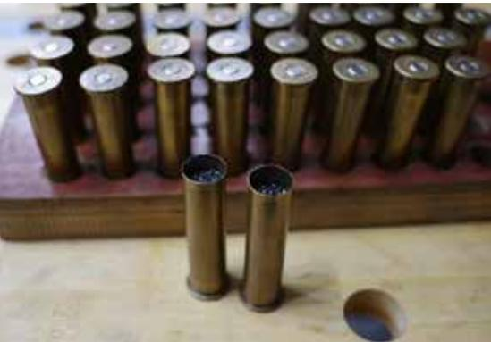
Die Verwendung ohne und mit Fallrohr beim Befüllen einer 45/70 Patronenhülse mit 70gr CH3.
