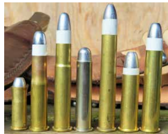
Dem Internet entnommenes Bild mit einigen Sharps-Patronen: .44-40 Winchester (zum Vergleich), .44-77 gepatchtes Papier, .44-90 gepatchtes Papier, .45-70 Karabinerladung, .45-110, .50-70 und Big .50 - .50-90.
