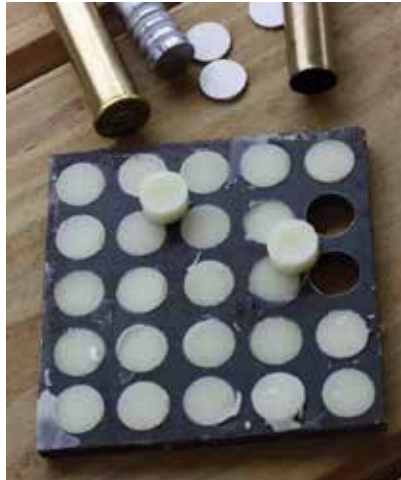
Dem Internet entnommenes Bild: Gießen von Schmiermittel Pfropfen mit festeren Schmiermitteln für die Verwendung in den .45/110 Patronen.
