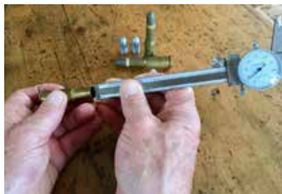
Dem Internet entnommenes Bild, Messen des Abstandes vom Hülsenmund zur Pulversäule mit einem Messschieber.
